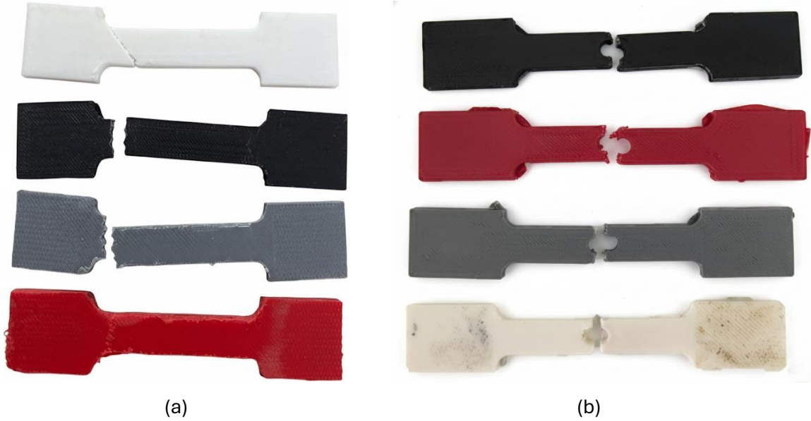
Görsel 5. Kontrol Grubu (a), Delikli Grubu (b) Çekme Testleri Numune Sonuçları
