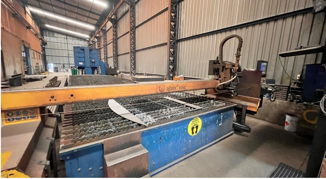
Şekil 0.3. AJAN CNC Plazma kesim tezgahı[21].
