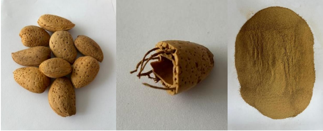
Görsel 1. Badem kabuklarının öğütme öncesi ve sonrası görüntüsü.
