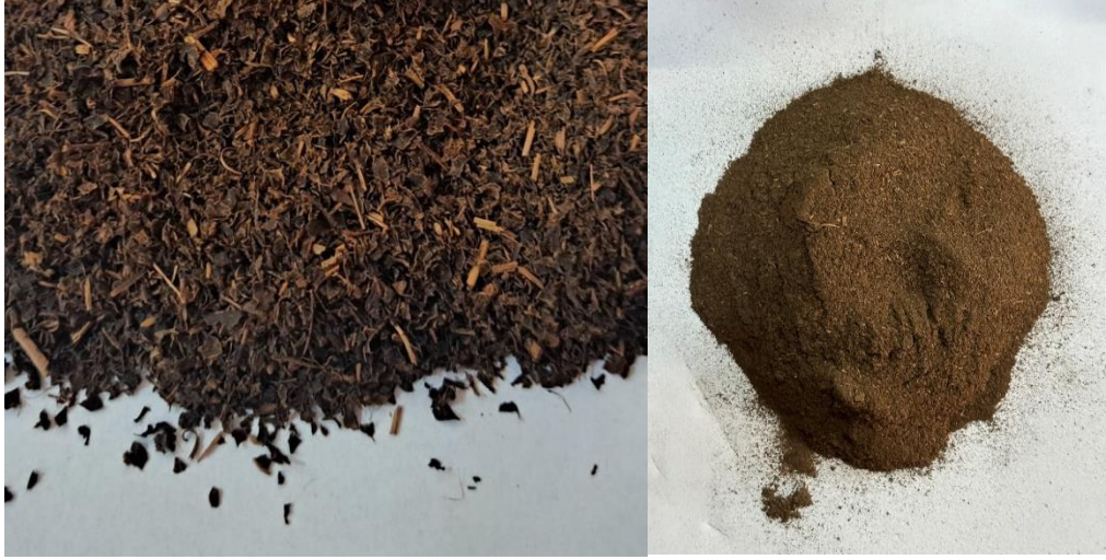
Görsel 1. Atık çayın öğütme öncesi ve sonrası fiziki görüntüsü
